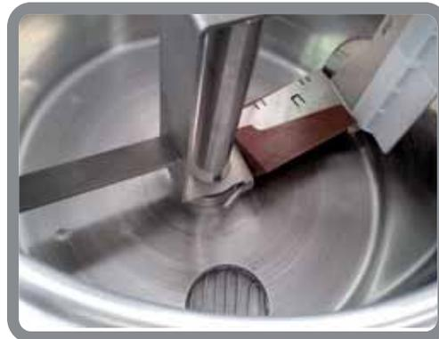
Agitatore con lama raschiante in polietilene (pe) a lunga durata. tutte le parti a contatto con la miscela o il gelato sono in acciaio inox e in materiale atossico facilmente accessibili e smontabili per la pulizia.
